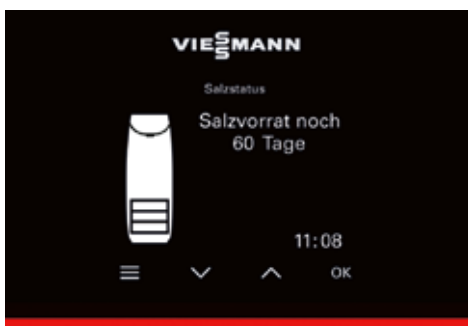
Displej a světelná signalizace Lightguide poskytují informace o aktuálním provozním stavu.
